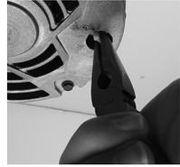
Apunte la flecha hacia el ajuste de voltaje deseado y pulse el interruptor hacia abajo en el motor. La flecha del interruptor debe ser suelta de la carcasa del motor cuando está correctamente instalada.
