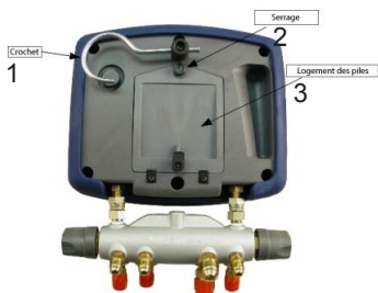
Figure 6-1. Logement des piles
