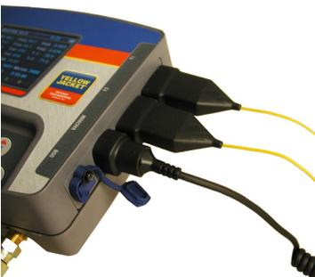
Figura 2-12. Sensores con accesorios
