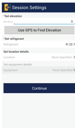
L'utilisation des réglages corrects spécifiques au système actuel que vous examinez permet d'obtenir les meilleures mesures de pression possibles ainsi que les meilleures mesures des valeurs de saturation de vapeur et de saturation liquide.
