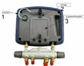
Figure 6-1. Logement des piles
