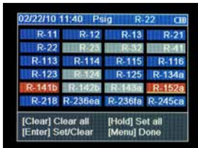
Abb. 5-4. Kältemittel Favoriten Einstellanzeige
