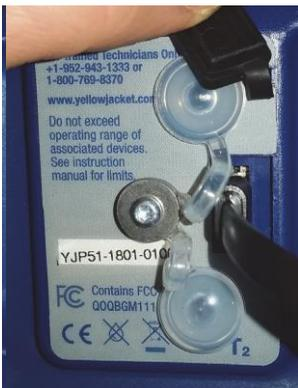
**ZUGRIFF AUF DATA LOG FILES** - Schließen Sie das Gerät über das mitgelieferte USB-zu-Micro-USB-Kabel an einen PC an, und schalten Sie das Gerät ein. Der P51-870 wird als Wechseldatenträger geöffnet. Datenprotokolle können zum Bearbeiten und Speichern auf den PC kopiert werden. Um das Gerät zu trennen, werfen Sie es wie ein entfernbares Flash-Laufwerk aus.
