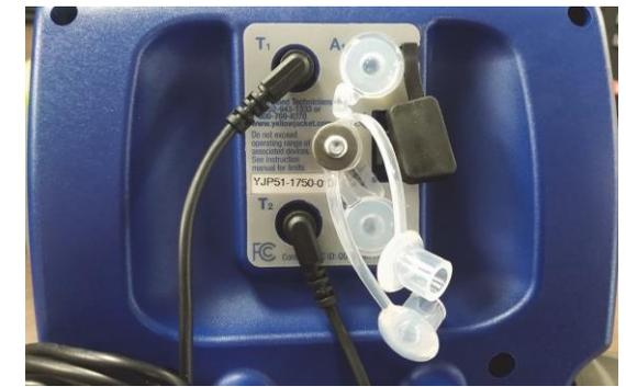
Stecken Sie den Temperaturfühler für den Niederdruck in T1 an der Rückseite des Geräts. Stecken Sie den Temperaturfühler der Hochdruck in T2 an der Rückseite des Geräts.
