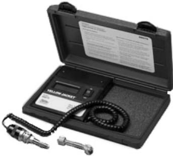
Dieses tragbare, leichte Festkörperinstrument zeigt den Vakuumdruck im System mithilfe von Thermoelementtechnologie an. Dies ist wichtig, da Sie zur Bestätigung der Feuchtigkeitsentfernung das Vakuum kennen müssen. Das batteriebetriebene Messgerät misst Luftdrücke von 760.000 bis 1 Mikron in gut lesbaren 1,25 cm großen Zahlen. (Teilenummer 69075)
