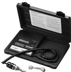
Der YELLOW JACKET® Omni™ digitale Vakuummesser ist ein einfach zu bedienender kompakter Vakuummesser mit einem Funktionsumfang, der dem Preis-Leistungsverhältnis entspricht. Einfach Soll-Vakuumniveau einstellen und der OMNI sendet akustische und visuelle Signale, wenn das Niveau erreicht ist. Der einfach zu reinigende Vakuumsensor verarbeitet 31,03 bar (450 psi) Überdruck und liest mehrere Vakuumeinheiten (Mikron, Millibar, Torr und Pascal) **(Teilenr. 69020)**.
