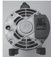
Die Garantie erlischt, wenn die Einstellung der Spannungsreglung an der Vakuumpumpe nicht dem Stromversorgungsanschluss entspricht. Motoren mit zwei Spannungen sind auf 230 V/50 Hz werkseingestellt.
