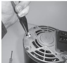
NOTA: No trate de girar o rotar el interruptor antes de levantarlo y que esté suelto.
