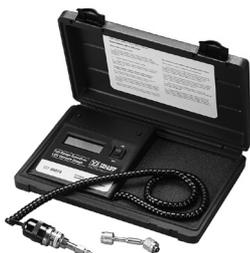
El medidor de vacío LCD de SuperEvac™ es un instrumento portátil, liviano y sólido que indica la presión del vacío en el sistema mediante la tecnología de termopar. Esto es importante ya que debe conocer el vacío para confirmar la remoción de humedad. El medidor con batería mide presiones atmosféricas de 760 000 a 1 micra en números de 1,28 cm (1/2 in) fáciles de leer **(Pieza n.º 69075)**.
