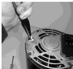
Nota : No trate de girar o rotar el interruptor hasta que se ha levantado y está suelto.
