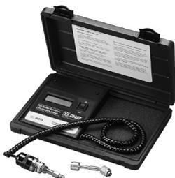
La jauge à vide à LCD SuperEvac™ est un instrument portable, léger et solide qui mesure la pression vacuométrique du système au moyen d'un thermocouple. Cette donnée est essentielle, car il est nécessaire de connaître le niveau d'aspiration pour confirmer l'élimination de l'humidité. Cette jauge à batterie affiche les pressions atmosphériques de 760 000 à 1 micron sous forme de chiffres très lisibles d'environ 1,3 cm (1/2 po). (réf. 69075).
