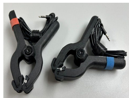
Figure 6 : Pince de température TITAN® P/N 40846 incluse
