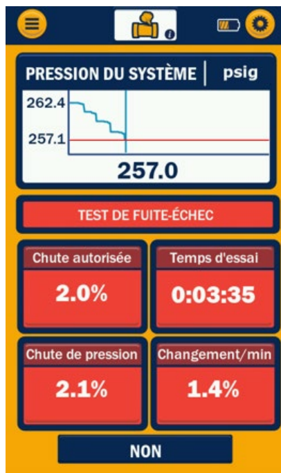
Figure 24: Test de décroissance de la pression - ÉCHEC
