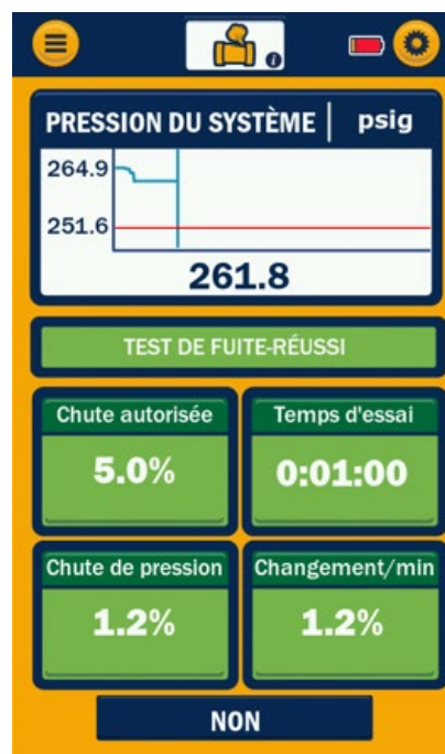
Figure 25: Test de décroissance de la pression - RÉUSSITE
