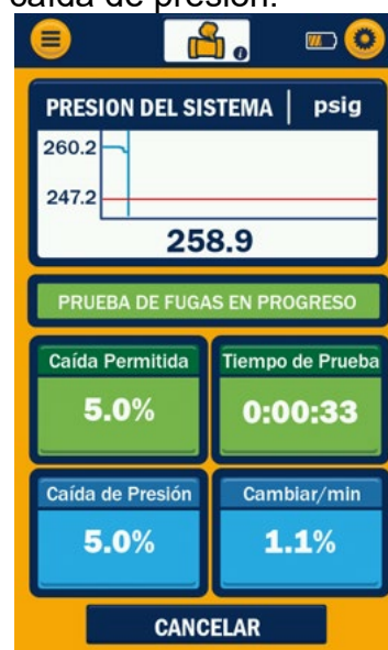
Figura 22: Menú Configuración Prueba de caída de presión
