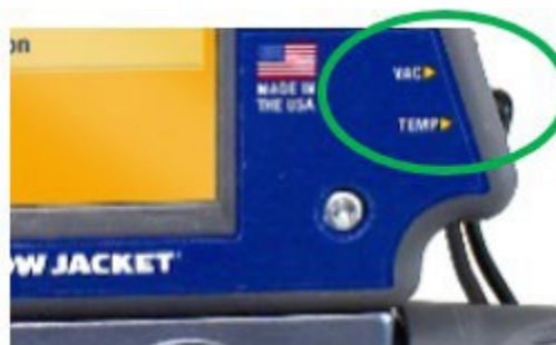
Figura 10: Conexión del sensor de vacío
