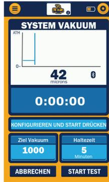
**Evakuierung Sitzung** zeigt Vakuum-Messwerte, gemessen mit einem YJ-Hilfsvakuum Sensor. Stecken Sie den Vakuumsensor in den Anschluss oben rechts an der Seite des Gerätes oder schließen Sie das YJACK VAC® Gerät an.
