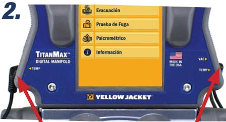
2. Stecken Sie den Niedertemperaturfühler in den Anschluss T1 an der linken unteren Seite des Geräts.
