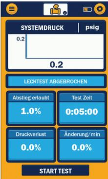
**Leaktest-Sitzung** zeigt Druck Veränderung im System, während ein stehender Druckprüfung. Zulässiger Abfall ist der Prozentsatz des aktuellen Systemdruck, der erlaubt ist bevor die Prüfung als Fehlschlag gewertet wird. Stellen Sie den zulässigen Druckabfall Prozentsatz.
