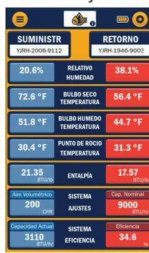
**Psychrometrische Sitzung** zeigt Systemdaten basierend auf YJACK DEW® Informationen. Die Daten werden manuell eingegeben für den tatsächlichen Luftstrom (durch das Antippen auf des Feld für volumetrische Luft), Nennleistung. Die aktuelle Kapazität wird berechnet und verglichen, um einen Systemwirkungsgrad zu bekommen.
