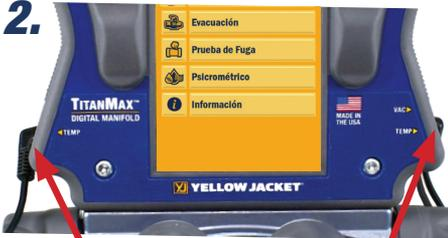
Conectar la sonda de temperatura del lado bajo en T1 en el lado inferior izquierdo del dispositivo.
