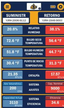
La sesión psicrométrica muestra los datos del sistema basados en la información de YJACK DEW®. Los datos se ingresan de forma manual para el flujo de aire real y la capacidad nominal. Se calcula y se compara la capacidad actual para obtener la eficiencia del sistema.
