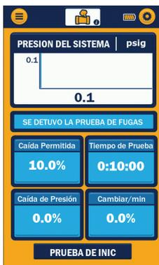
La sesión de prueba de fuga muestra el cambio de presión en el sistema durante una prueba de presión permanente. El cambio permitido es el porcentaje en el que se permite que caiga la presión actual del sistema antes de que la prueba se considere fallida. Establecer el porcentaje de cambio permitido.
