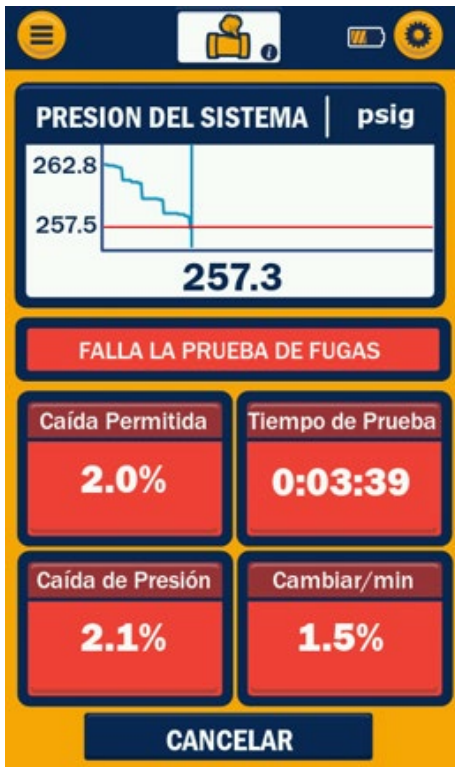
Figura 24: Prueba de caída de presión - FALLA
