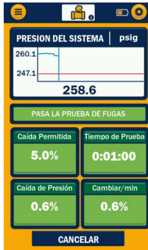
Figura 25: Prueba de caída de presión - PASA
