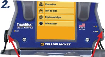
Branchez la sonde de température du côté bas sur T1 en bas à gauche de l'appareil.
