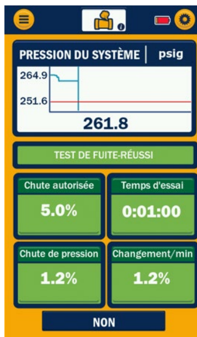
Figure 25: Test de décroissance de la pression - RÉUSSITE
