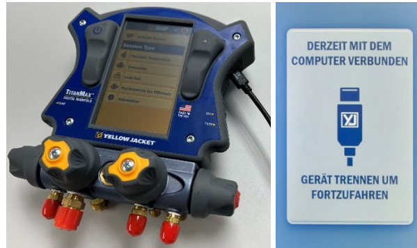
Abbildung 15: Anschluss an den Micro-USB
