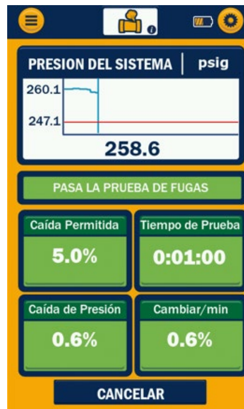
Figura 25: Prueba de caída de presión - PASA
