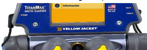
Figura 7: Conectar las sondas de temperatura
