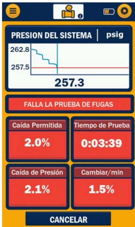
Figura 24: Prueba de caída de presión - FALLA
