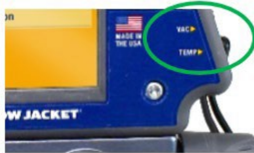
Figura 10: Conexión del sensor de vacío
